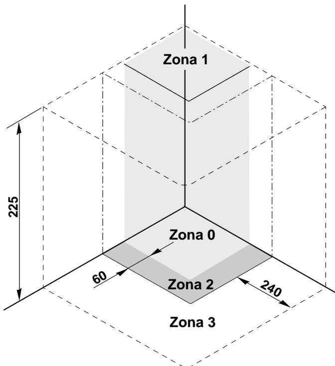
L'installazione della Colonna deve essere eseguita da personale abilitato o qualificato, sia per quanto riguarda il collegamento elettrico che quello idraulico. Prima di procedere al collegamento, l'installatore deve accertarsi che l'impianto elettrico sia conforme alle norme **CEI 64.8**, protetto da un interruttore differenziale 0,03A, e che l'impianto di messa a terra sia efficiente e conforme alle disposizioni sopracitate.
